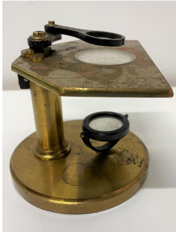
Före konservering. Lacken är delvis borta
